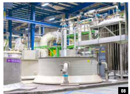
07. 08. Circuit Foil occupe un terrain de 8 ha à Wiltz et emploie plus de 300 personnes. L'usine abrite principalement les grandes cuves des différents bains nécessaires à la fabrication des feuilles de cuivre. Ces installations vont être agrandies prochainement pour une augmentation de la production de 30% à l'horizon fin 2021/ début 2022.
