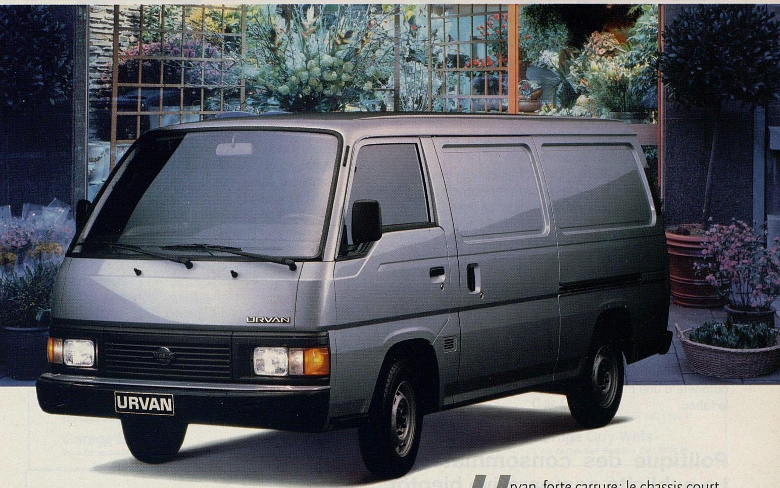
Urvan, forte carrière: le chassis court embarque 1.250 kg, le chassis long offre 6,4 m<sup>3</sup> d'espace ■ Manutention accélérée avec le plateau de charge à 58 cm du sol, les 2 portes latérales coulissantes, le choix à l'arrière entre le hayon et la double porte ■ Moteur essence 2000cc (64 kW) ou diesel musclé 2500cc (59 kW), freinage puissant avec disques AV ventilés, bien pour la route! ■ Chassis court ou long; versions vitrée, tôlée, fourgon surélevé en option,
