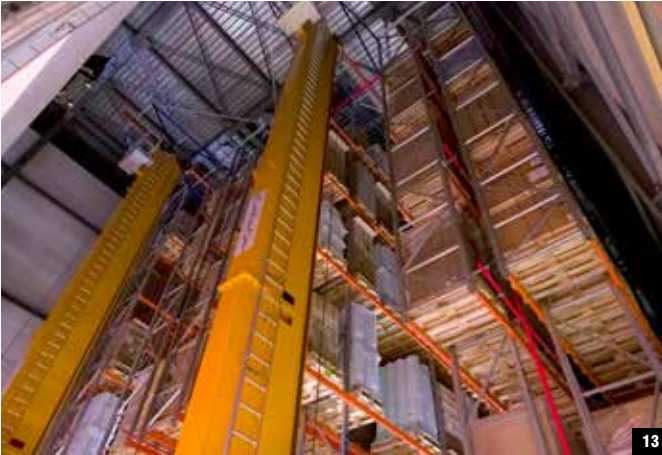
13. Les nouvelles technologies robotisées mises en place dans les entrepôts permettent de densifier les marchandises en utilisant la totalité des hauteurs des bâtiments.
