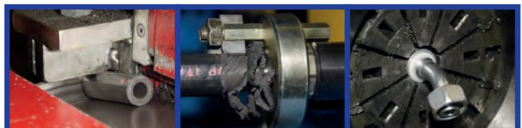
Wir sind in der Lage Hydraulikschläuche von 1/4" bis 2" Durchmesser und einem Betriebsdruck von bis 420 bar zu verpressen. (weitere Schläuche auf Anfrage)
