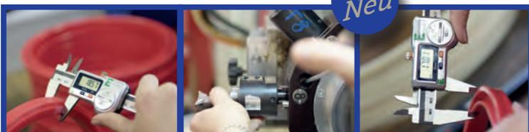
Durch unsere langjährige Erfahrung in Hydraulik-Zylinderreparaturen und mit Hilfe einer CNC-Drehmaschine, sind wir nun in der Lage, eine Vielzahl an Dichtungen kurzfristig nach Mass zu fertigen.
