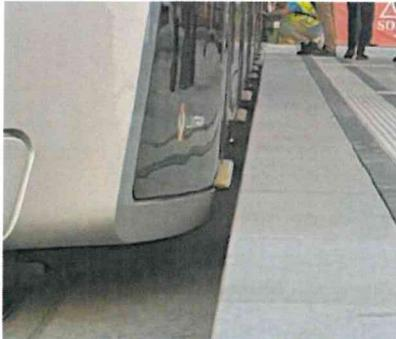
Figure 26 : Lacunes horizontales et verticales pour l'accès au tram pour les PMR
