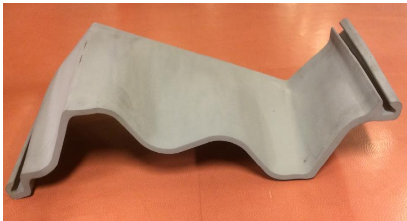
Figure 1 : échantillon montrant le dépliage dans la zone de laminage
