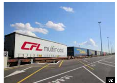
01. 02. Le centre logistique Eurohub Sud, géré par CFL multimodal, a une capacité de traitement de 300.000 containers et 300.000 semi-remorques par an. Ceux-ci sont chargés sur des trains qui empruntent des autoroutes ferroviaires à destination de l'Europe entière.
